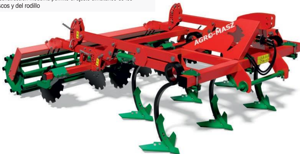
ajuste hidráulico de la profundidad de trabajo
