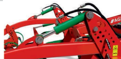
ajuste hidráulico de la profundidad de trabajo
