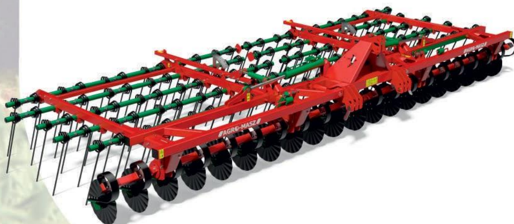
fila des discos con regulación hidráulica 460 mm
