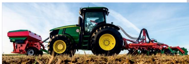
IKAR + RUNNER - set para el cultivo y la fertilización simultánea del suelo
