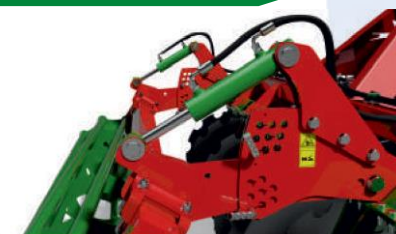
ajuste hidráulico de la profundidad de trabajo
